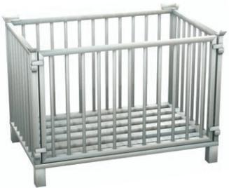
**aus Edelstahl 1.4301**, mit Eckfüßen bzw. Längskufen, verschweißt, stapelbar, Längssprossen aus Profil 60 x 30 mm, Sprossenabstand 63 mm, Gitterrahmen aus Profilrohr, Füllhöhe: 700 mm, Tragfähigkeit: 1000 kg
