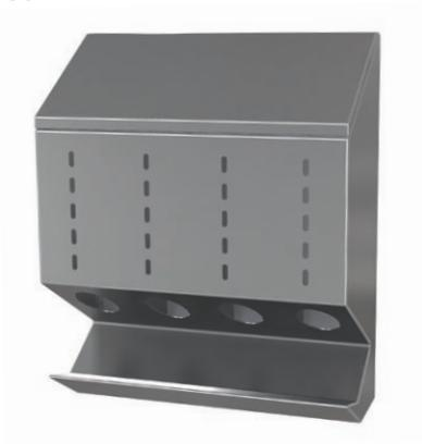
aus Edelstahl 1.4301, Oberfläche gebürstet, zur einfachen Ausgabe von Einwegartikeln (wie Handschuhe, Haarnetze, Überziehschuhe und Gesichtsmasken), obere Einfüllöffnung mit Abdeckung, untere Entnahmeöffnungen, Füllstandkontrolle über Schlitzöffnungen, mit Auffangwanne, zur Wandmontage vorbereitet
