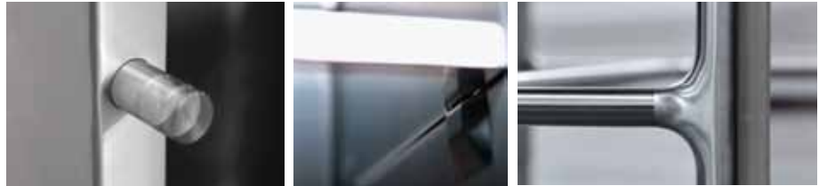
Bild 3: (a) Push2Open Beschlag als hygienische Detaillösung zum Öffnen von Türen, (b) Nahtlos tiefgezogene Fachbodenauflagen mit leicht zu reinigenden Radien, (c) Nahtfreie Übergänge an Rohrkonstruktionen am Beispiel eines Tischnuntergestells
